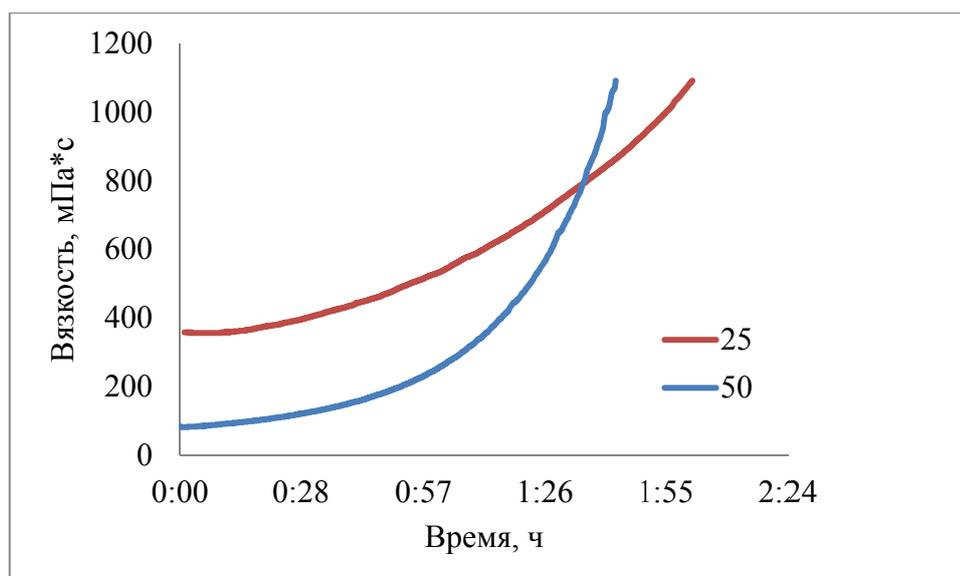
Изменение вязкости связующего ТК123 от времени при изотермической выдержке в при температурах 25 и 50°C
